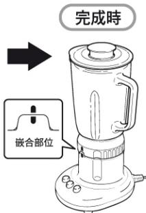
拆解時請將底座依下圖箭頭方向旋轉進行拆解。
